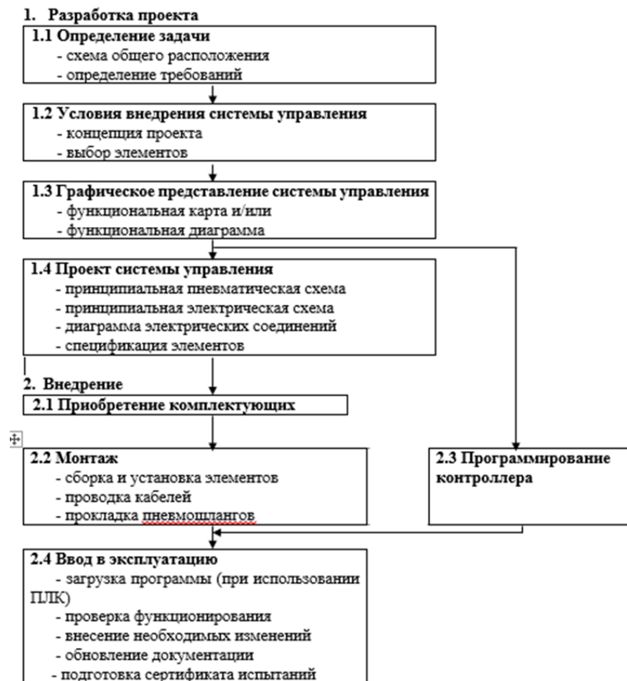
Рисунок 2 - Алгоритм разработки и внедрения электропневматической системы управления
