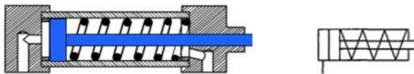
Рисунок 1 – Пневмоцилиндр одностороннего действия
