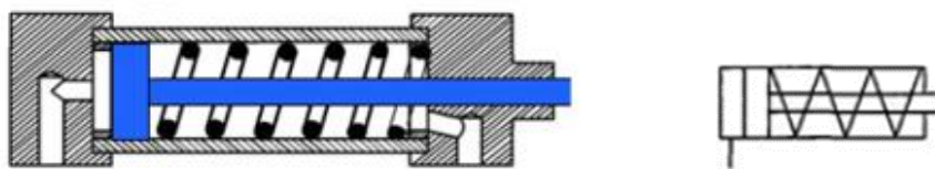
Рисунок 2 – Пневмоцилиндр одностороннего действия
